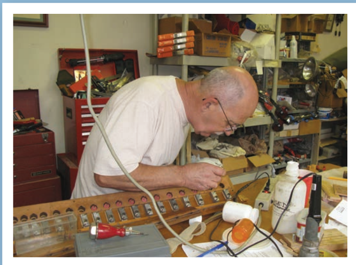
Andy Gallien rebuilding a Wurlitzer bottom board
